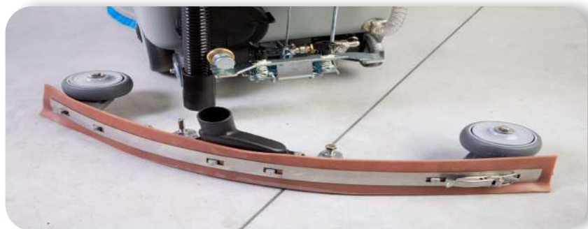
lo squeegee oscillante segue il movimento della macchina the oscillating squeegee follows the machine movement
